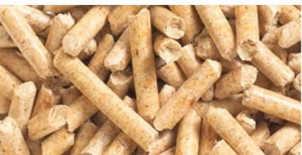
Lesni peleti so iz neobdelanega lesa. Neobdelana oblovina in žagovina, ki nastajata kot stranski proizvod v lesnopredelovalni industriji, sta stisnjeni in peletirani. Zaradi visoke gostote energije, enostavne dobave in skladiščenja so se peleti izkazali za optimalno gorivo za ogrevalne naprave s popolnoma samodejnim delovanjem. Dobava pelet poteka s cisternami, ki omogočajo neposredno polnjenje skladišča.
