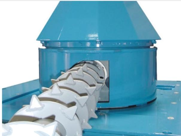
Masivna konstrukcija za odpornost proti izredno veliki sipki teži pri iznosih iz visokih skladišč. Se uporablja predvsem pri odrezkih in zbiralnikih z večjimi premeri.
