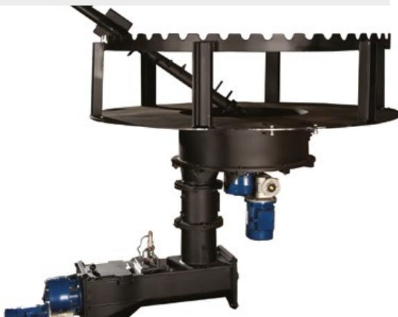
Se uporablja predvsem kot iznosni polž iz skladišča v lesno predelovalni industriji. Skrbi za enakomerno in zanesljivo doziranje goriva iz visokih skladišč.
